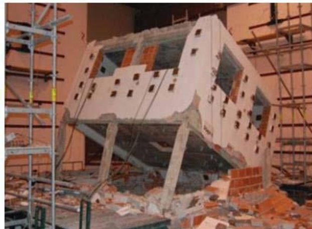
تصویر شماره ن ۷۲۹: ۱-۱۳: فروریزش فارغ از صفحه میانقاب دو لایه فاقد میلگرد بستر
