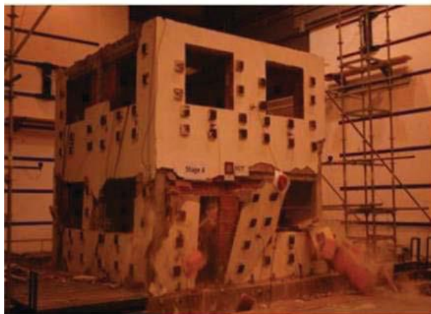
تصویر شماره ن ۷۲۹: ۱-۱۳: فروریزش فارغ از صفحه میانقاب دو لایه فاقد میلگرد بستر
