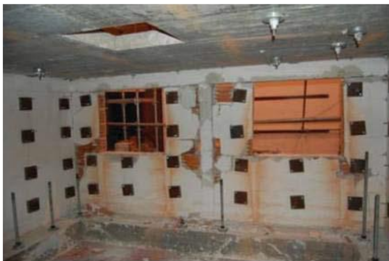
تصویر شماره ن ۷۲۹: ۱-۱۴: مفض پایداری خارج از صفمه میانقاب تک لایه به واسطه استفاده از میلگرد بستر
