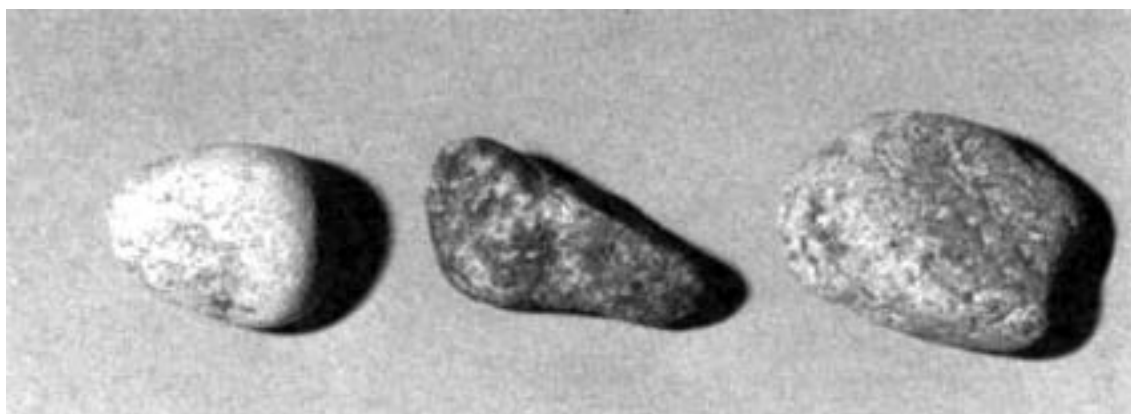
شکل ۷- سنگدانه غیر شکسته (سنگدانه‌های گرد گوشه با سطوح صاف)
