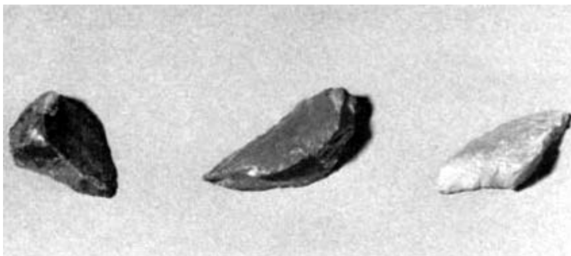
شکل ۳- سنگدانه شکسته (لبه‌های تیز، سطوح صاف)
