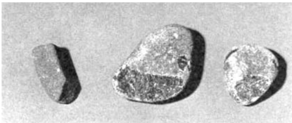
شکل ۵- یک سنگدانه شکسته در وسط و دو سنگدانه غیر شکسته در طرفین (که فقط لب پریدگی دارند)
