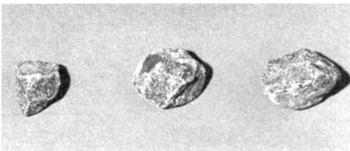
شکل ۴- سنگدانه شکسته (لبه‌های مدور، سطوح ناصاف)
