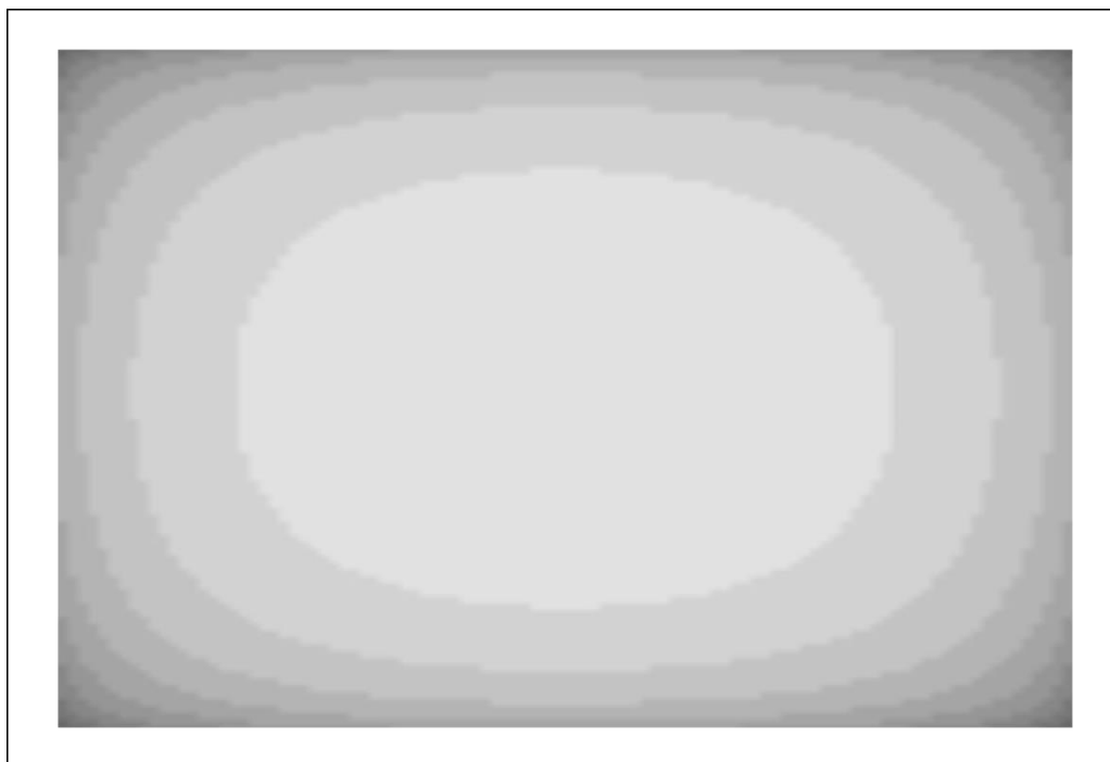
شکل ۷-۱۳ - شمای کلی توزیع k_s در سطح پی منعطف با استفاده از روش پیشنهادی
